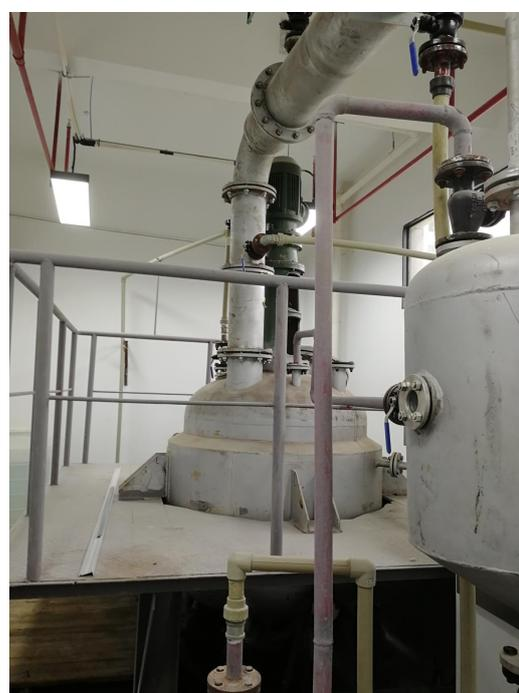
真空蒸发浓缩结晶处理装置
